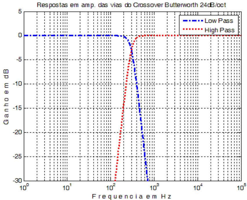
Sendo assim, continua a ocorrência do “calombo” de 3dB na frequência de crossover, porém pode-se observar no gráfico abaixo que para a simples superposição das vias - “LP + HP” - não ocorre o *notch*.
