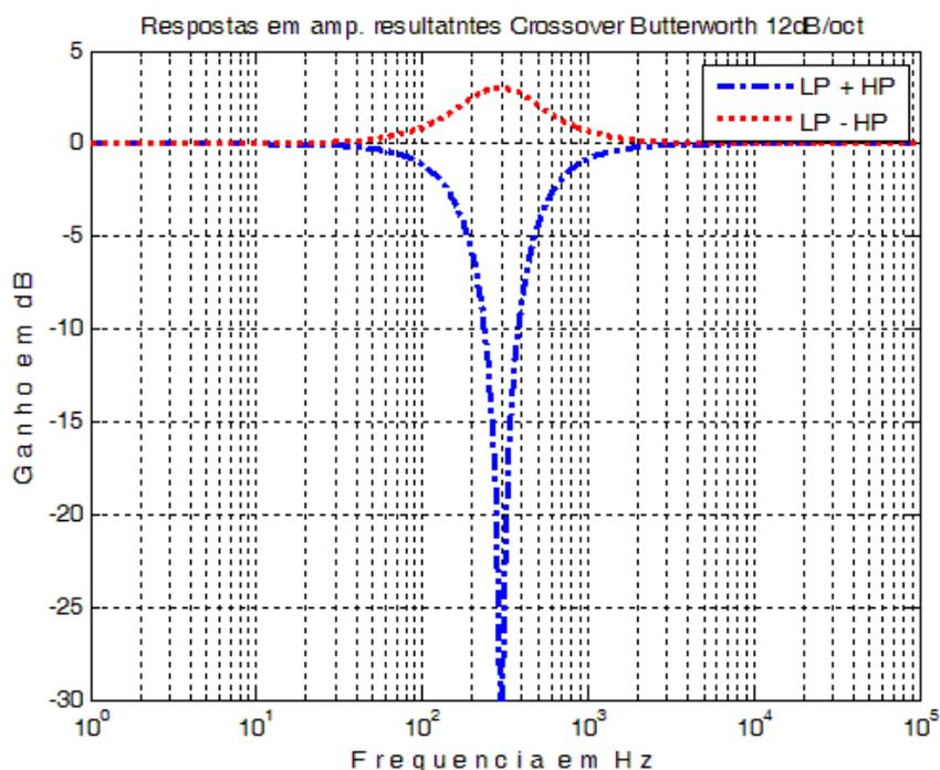
Pode-se observar no gráfico anterior, que para a simples superposição das vias – “LP + HP”, ocorre o surgimento de um *notch* no espectro resultante. Isto ocorre devido ao fato dos filtros *high-pass* e *low-pass* de segunda ordem apresentarem uma defasagem de 180 graus - sendo 90 graus de defasagem para cada polo dos filtros.
