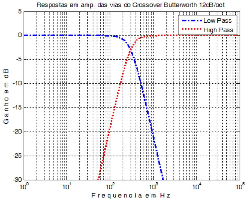
O objetivo dos Crossovers, é que na saída do sistema a superposição das vias resulte no sinal original. Porém, devido à característica de -3dB na frequência de corte dos filtros Butterworth, a superposição final das vias apresenta uma amplificação de 3dB a frequência de crossover.
