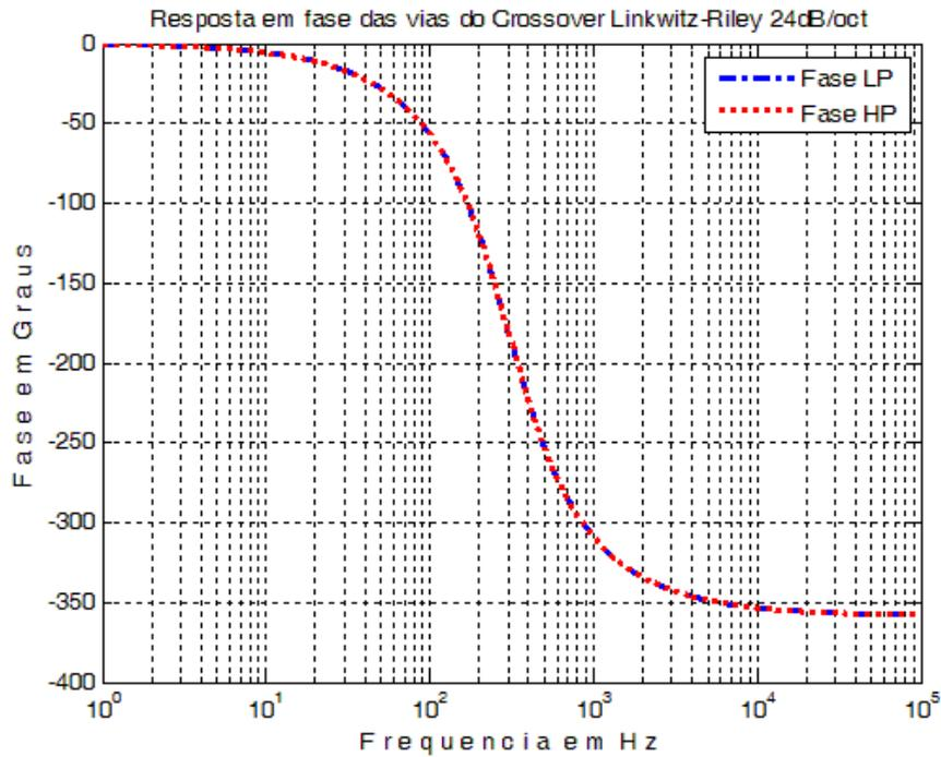
Sendo assim, não há a necessidade de inversão de uma via para que a superposição ocorra de modo perfeito.
